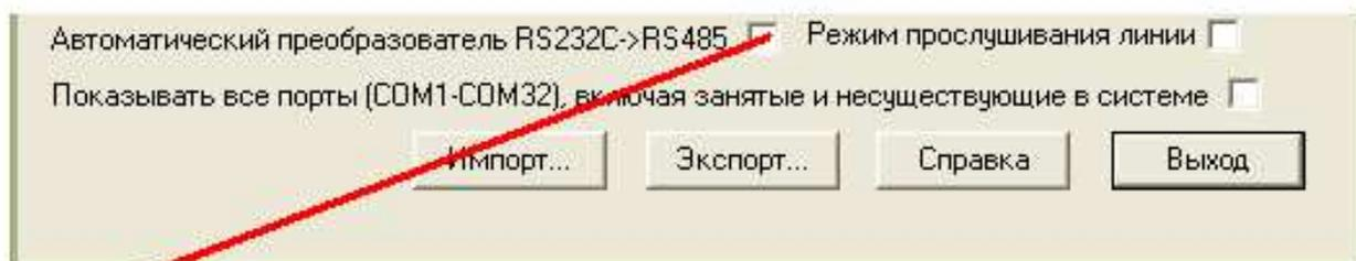
поставить если AC-3M, Или AC-4, иначе снять
