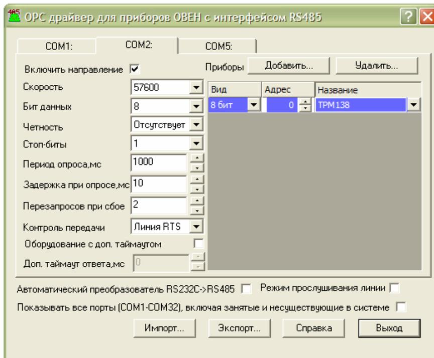
Установите параметры Автоматического преобразователя в зависимости от типа преобразователя.
